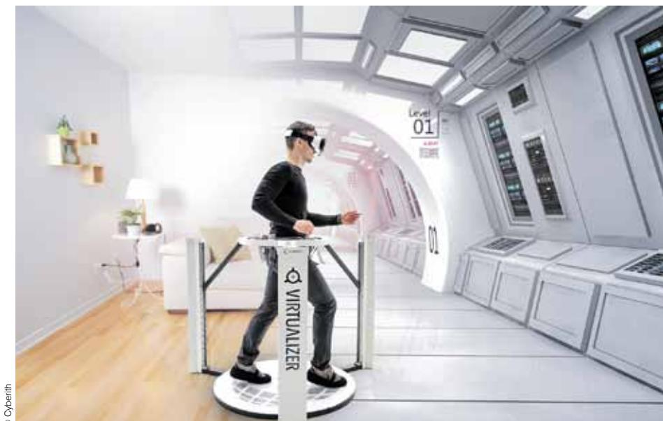
**Österreichische Innovation** Der Virtualizer (Hersteller Cyberith) ist eine sogenannte omnidirektionale Treadmill, quasi ein Laufband, das einem ermöglicht, in alle beliebigen Richtungen zu laufen.
