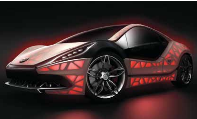
Dank eines LED-Hinterleuchtungskonzepts entstand beim Light Cocoon im Zusammenspiel zwischen Licht, Struktur und Stoff ein neuartiges Fahrzeugdesign.
