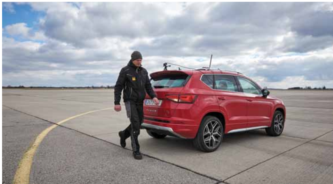
Schwachstelle: Im Test wurden Fußgänger hinter dem Auto oft gar nicht oder erst zu spät erkannt.
