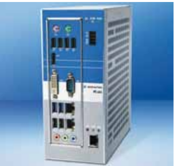
Der Schaltschrank PC 400 ist für einen 24/7-Dauerbetrieb konzipiert.
