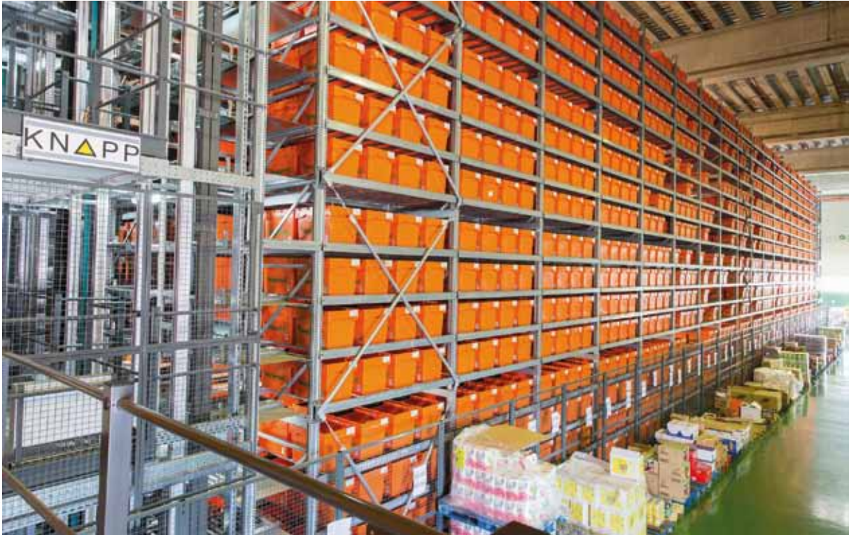
Die fertig kommissionierten Behälter mit den Kundenbestellungen werden im Versandpuffer, dem OSR Shuttle, eingelagert.
