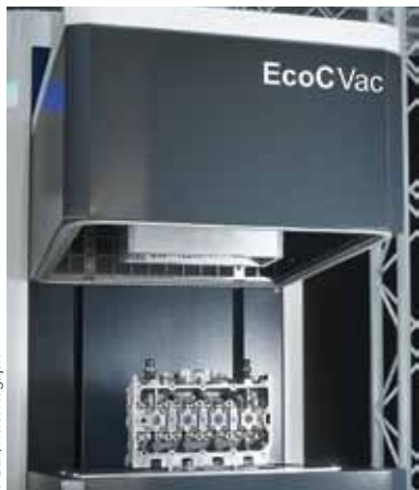
Das neue Trockenreinigungssystem EcoCVac.arbeitet ohne Druckluft.
