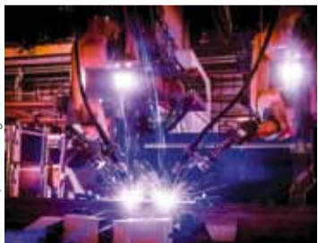
Die beiden Roboterarme können mit bis zu vier Lichtbögen schweißen.
