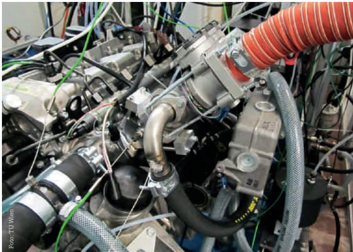
Mit Bio-Ethanol betriebener Motor am Prüfstand der TU Wien.
